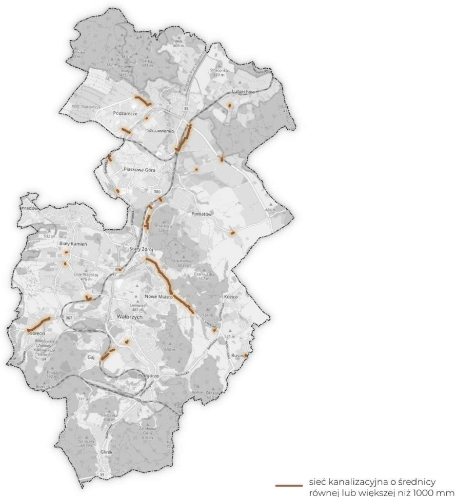
Rysunek 3 Rozmieszczenie kolektorów wód opadowych
