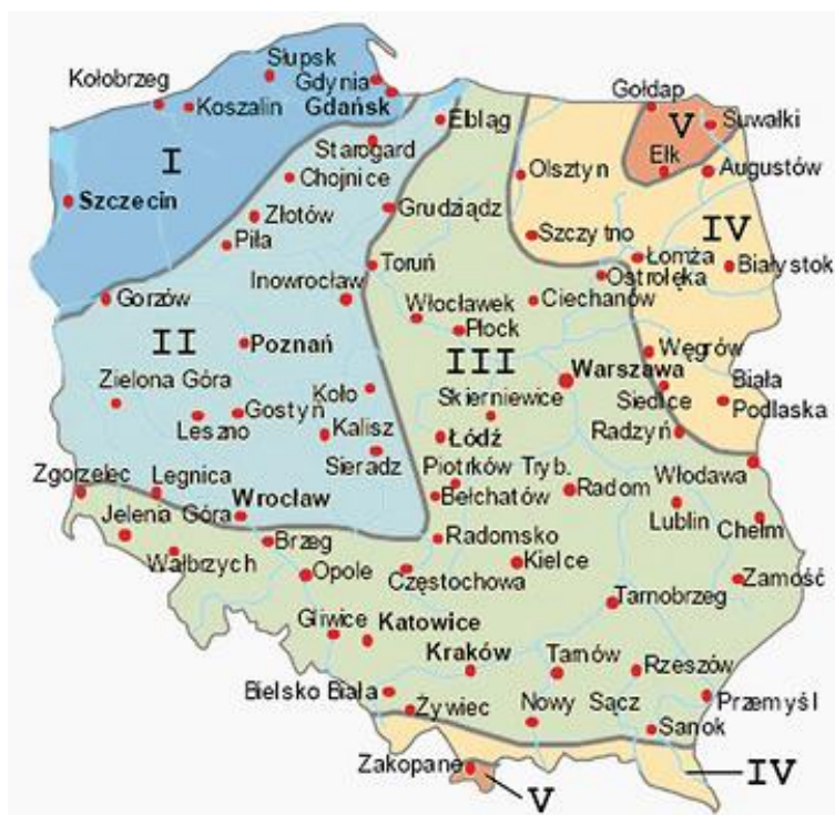
Rysunek 7 Mapa stref klimatycznych Polski i minimalne temperatury zewnętrzne Źródło: Podział Polski na strefy klimatyczne wg normy PN-EN 12831
