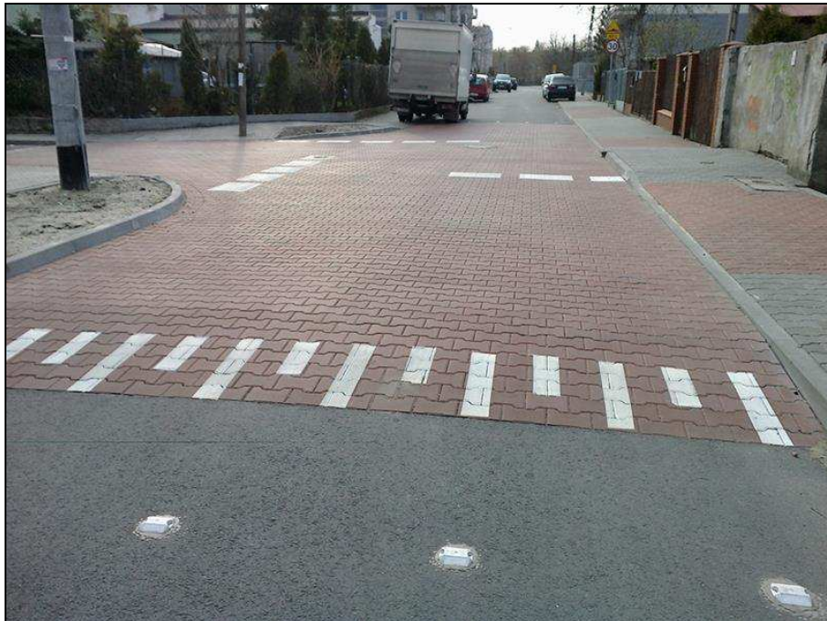
Rysunek nr 11. Przykład wyniesionego skrzyżowania [Źródło: zm.org.pl]
