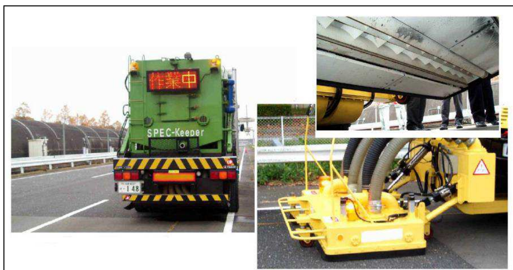
Rysunek nr 14. Sprzęt wykorzystywany przy oczyszczaniu nawierzchni z asfaltu porowatego [Źródło: Zastosowanie nowoczesnych technologii w konstrukcjach drogowych, Zakopane 15-17.09.2010 r.]
