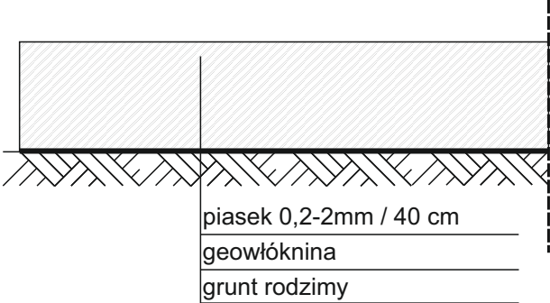
PRZEKRÓJ PRZEZ NAWIERZCHNIĘ - PIACH
