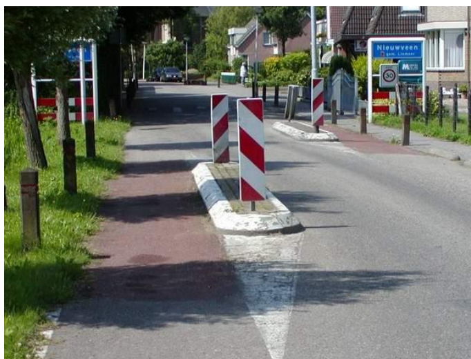
Rysunek nr 12. Przykład przewężenia jezdni [Źródło: zm.org.pl]
